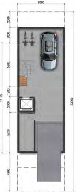
Mặt Bằng Tầng Hầm | Basement Floor
