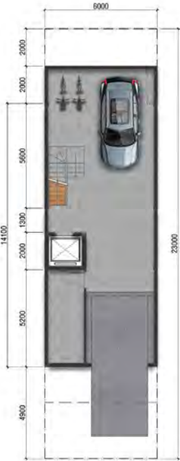
Mặt Bằng Tầng Hầm | Basement Floor
