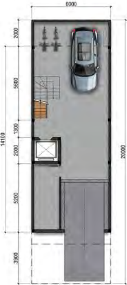
Mặt Bằng Tầng Hầm | Basement Floor
