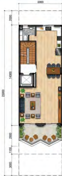
Mặt Bằng Tầng 2 | 2 nd Floor
